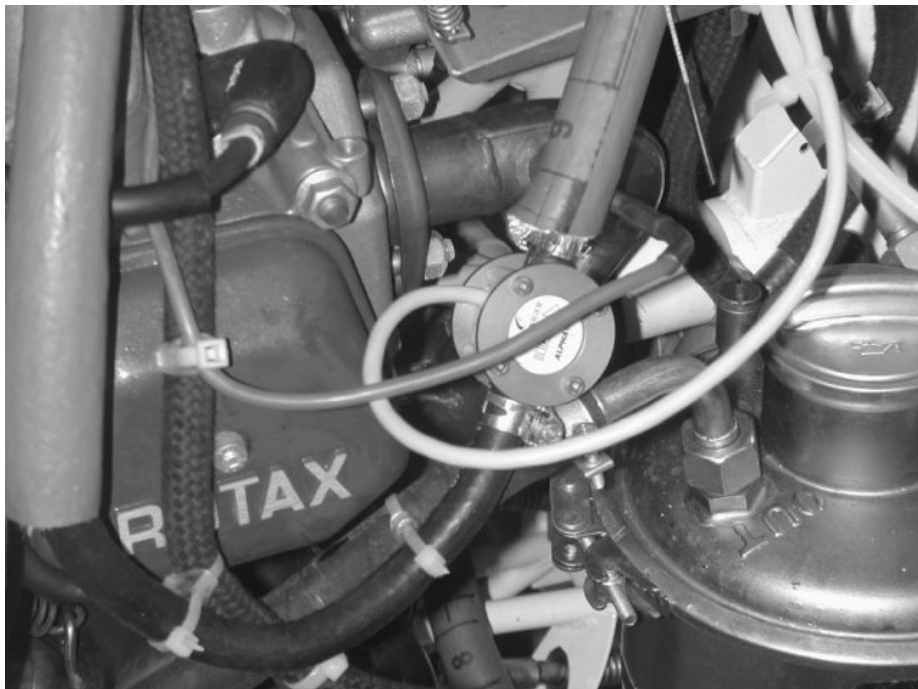
Einbau des Durchflussmessers in Rotax 912 S wie in Kap 5.3.6 beschrieben
