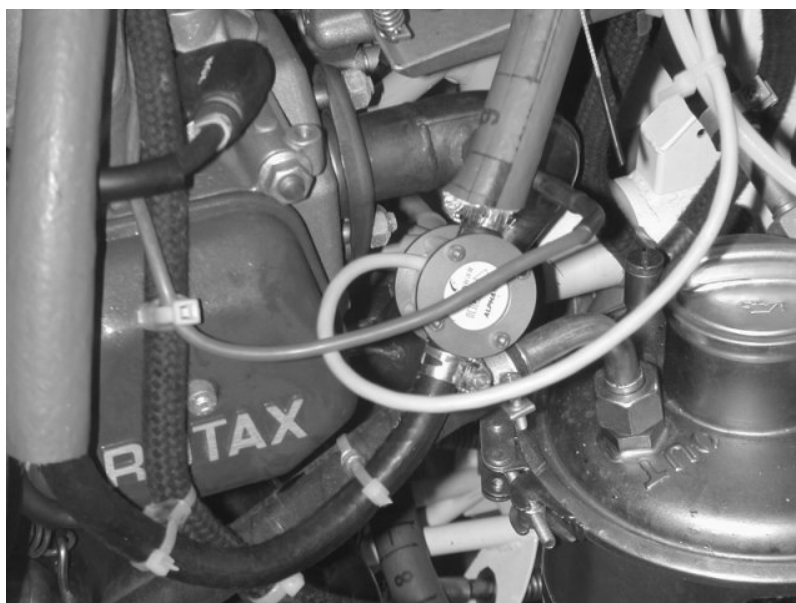
Sonde montée sur un Rotax 912 S comme décrit dans la Section 5.3.6
